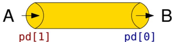
Les descripteurs d'un tube sont hérités par les processus fils.
